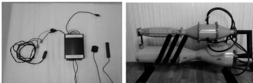
Рисунок 1 - Навигационно-связное устройство (слева) и устройство для очистки отработавших газов (справа)
