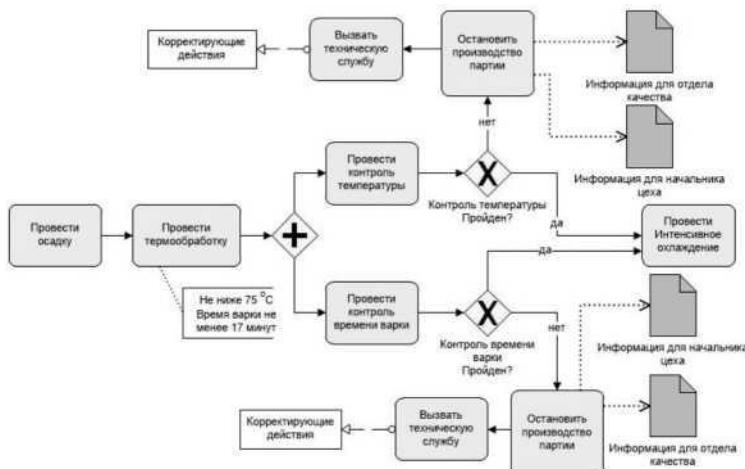
Рисунок 1 - Часть технологического процесса в нотации BPMN
