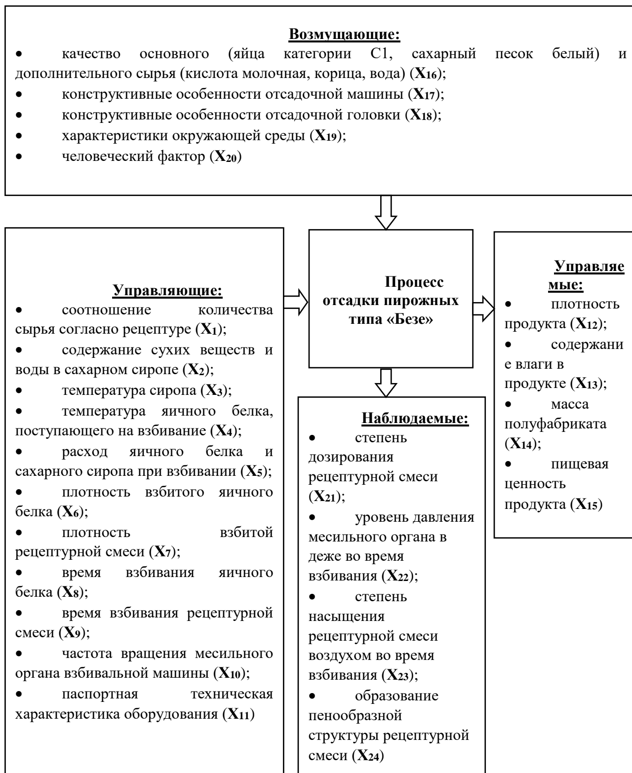
Рис. 1 Параметрическая схема процесса отсадки пирожных типа «Безе»
