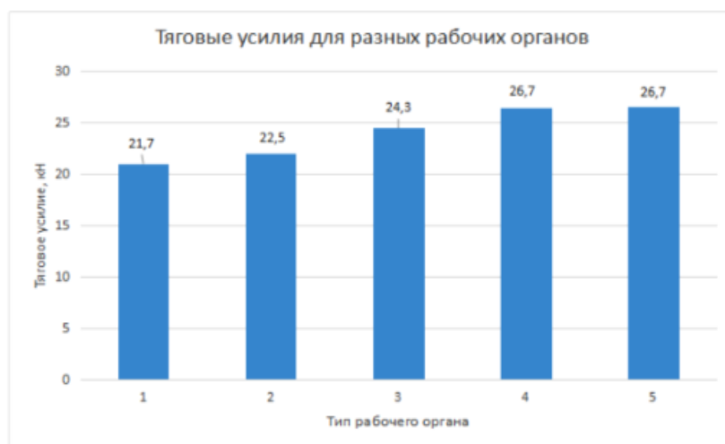
Рис. 1 - Гистограмма распределения тягового сопротивления 1 – для V-образного рабочего органа; 2 – с параболическими стойками; 3 – с параболическими стойками и дополнительным оборудованием
