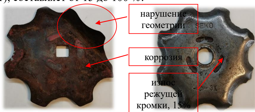
Рис. 1 Износ ножей типа «Звездочка» в период эксплуатации 3 месяца
