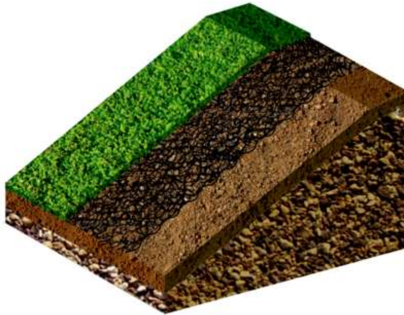
Рис. 1 Укладка противозерозионного материала - геомата на откос
