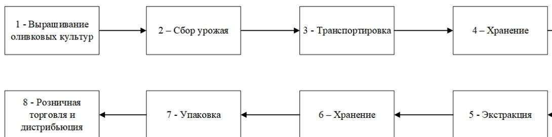
**Рисунок 1 – Типичные этапы процесса производства оливкового масла**
