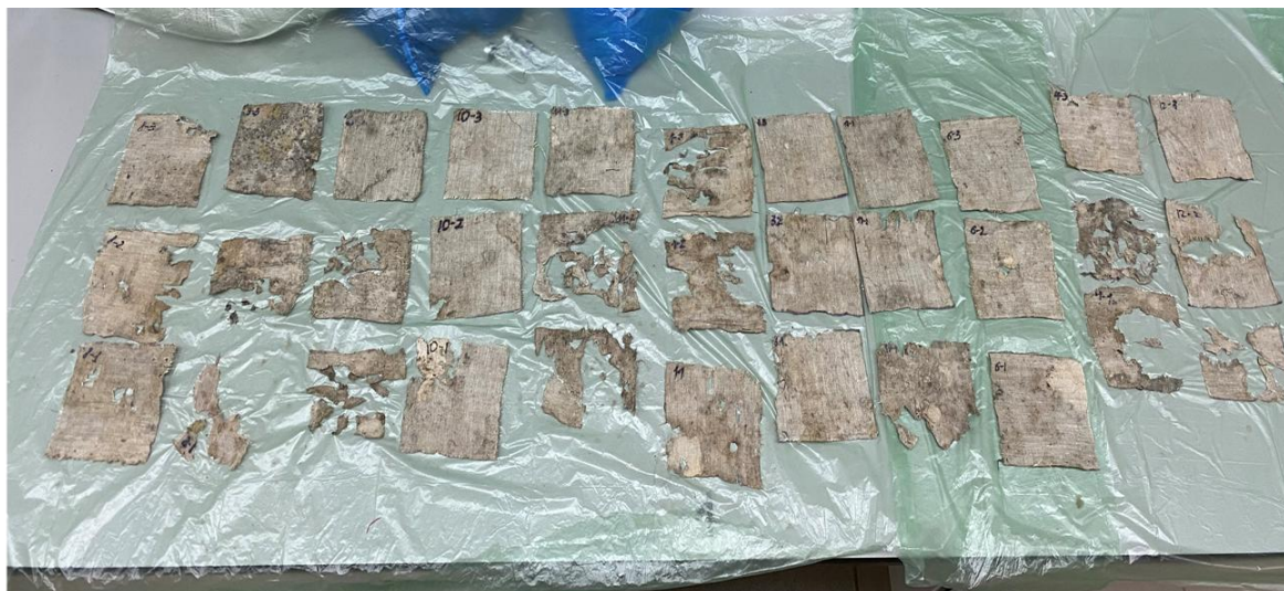
Рис. 1. Извлечённые образцы льняных полотен, подвергшиеся различной степени разложения
