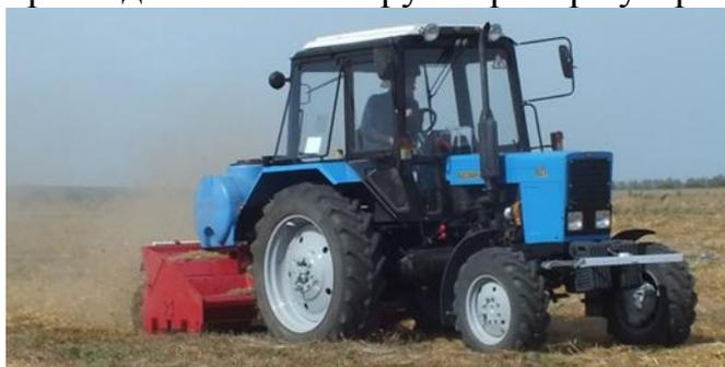
**Рис. Агрегат для утилизации незерновой части урожая в качестве удобрения**
