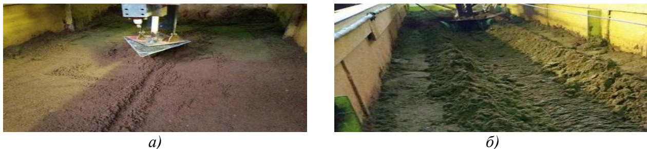
Рис. 2. Движение рабочего органа в грунтовом канале, вид спереди (а), и образованные боковые валика, вид сзади (б).
