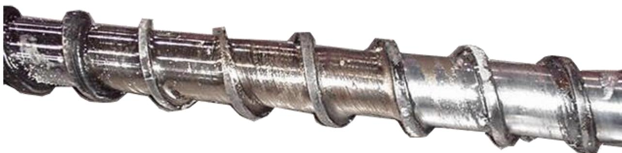
**Рис. 1 Абразивный износ шнека**
