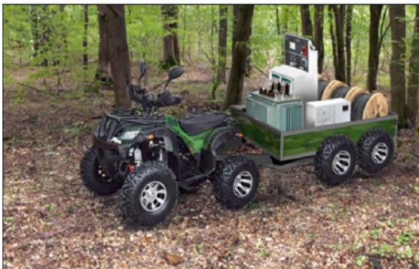
Рис. 2 Мобильная модульная трансформаторная подстанция
