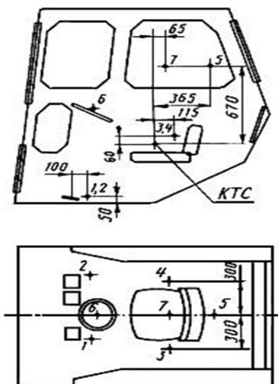
**Рис.1 Места измерения температуры воздуха в кабине трактора**
