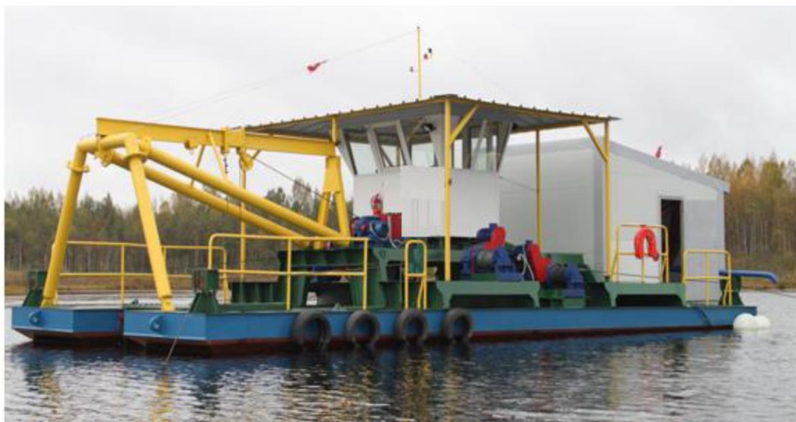
Рисунок 1 – Вид земснаряда, оснащенного грунтозаборным камерным комплексом, добывающего сапрпель на озере Веверу
