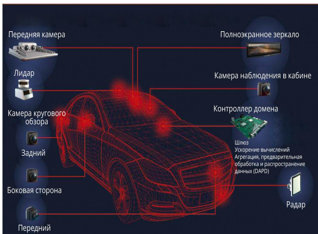
Рисунок 1 – Схема электромобиля с датчиками и процессорами
