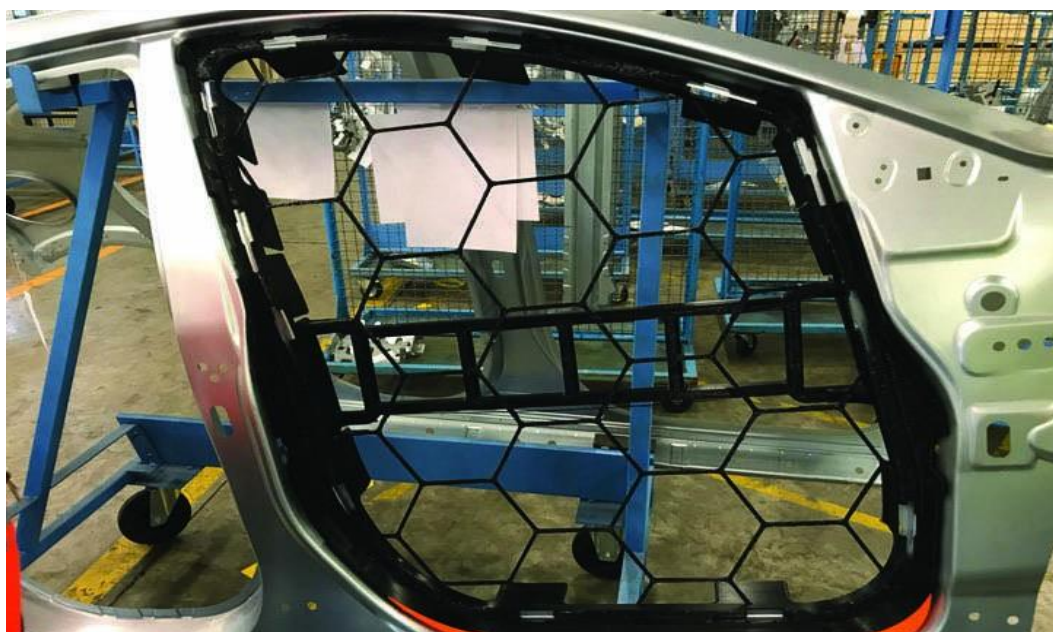
Рисунок 1 – Корпус автомобиля компании BMW с применением аддитивных технологий
