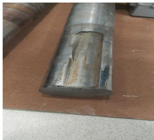
Рисунок 2 – Шпоночный паз вала:
