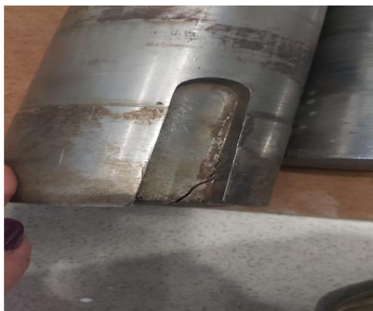
Рисунок 2 – Шпоночный паз вала:
