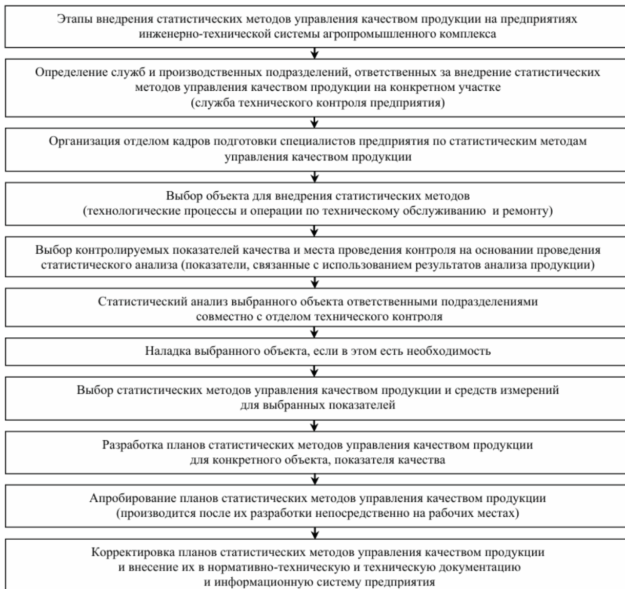
Рисунок 1 – Этапы внедрения статистических методов управления качеством на предприятиях ТС АПК
