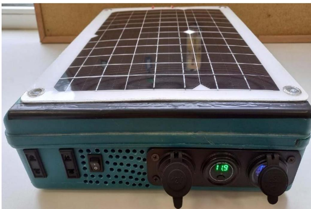
**Рисунок 2 – Внешний вид портативного автономного источника электроэнергии**
