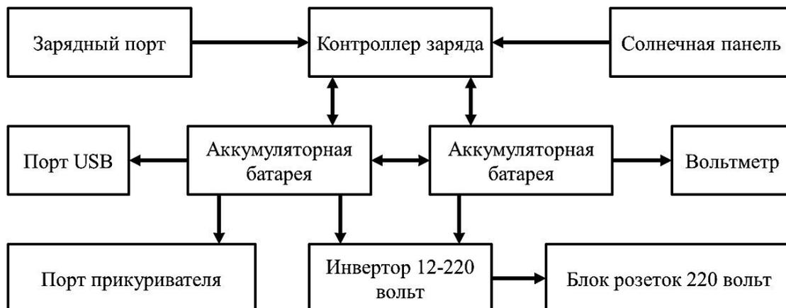
**Рисунок 1 – Принципиальная схема портативного автономного источника электроэнергии**
