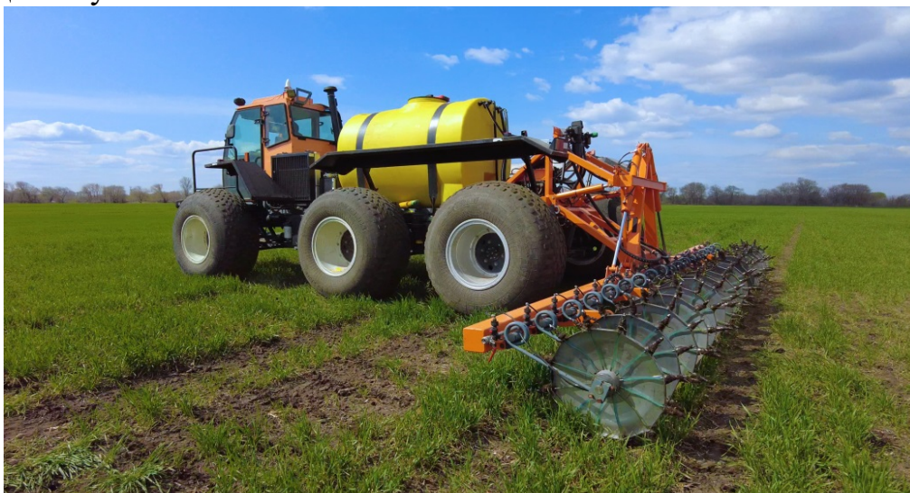
Рис.1. Инновационный самоходный агрегат-мультиинжектор ООО «Пегас-Агро» для внутрипочвенного внесения жидких удобрений
