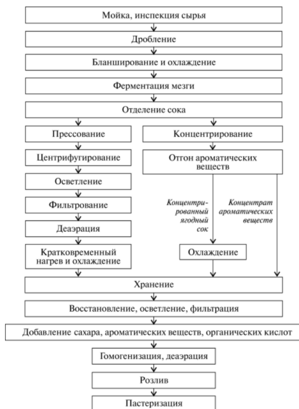
Рисунок - Технологическая схема производства плодово-ягодных соков
