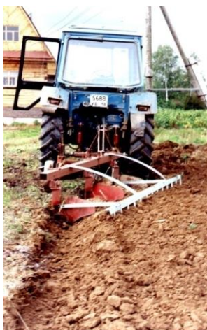
Рисунок 2 Комбинированный пахотный агрегат на вспашке почвы на мелкоконтурном участке в личном подсобном хозяйстве
