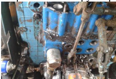
**Рисунок 1 – Результат повышенного перегрева**
