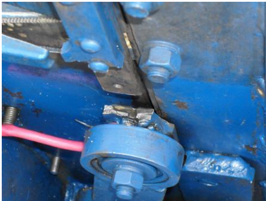
Рисунок 1 – Излом головки ножа
