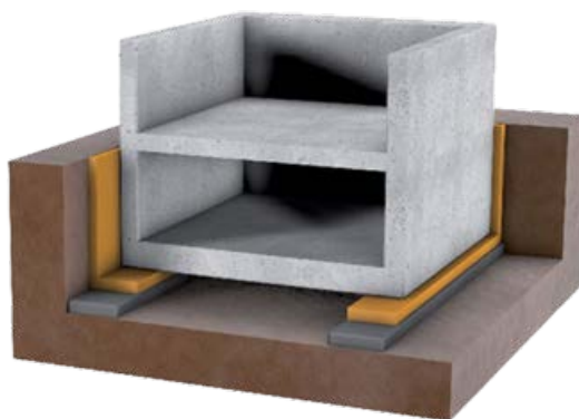
Рис. 2 Устройство здания на упругой ленточной опоре [4]
