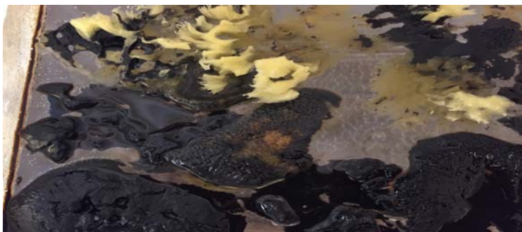
Рис. Сорбция нефти за счет капиллярного эффекта
