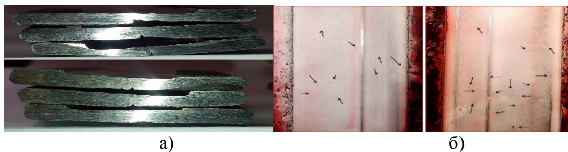
Рис. 2 Дефекты: а) непровары на макрошлифах; б) несплошности выявленные капиллярной дефектоскопией
