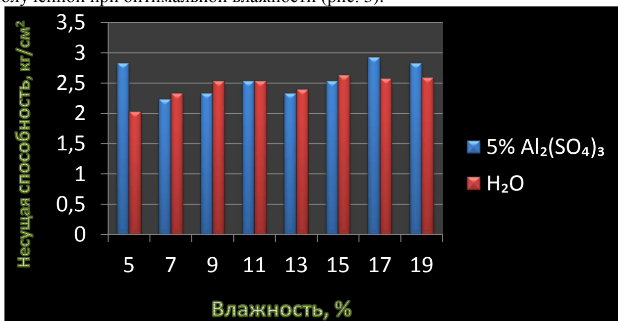
Рис. 3 Максимальные значения несущей способности, при увлажнении различным раствором.
