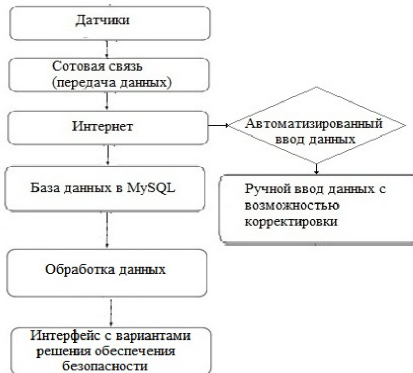
Рис. 1. Схема принципа работы автоматизированной системы мониторинга
