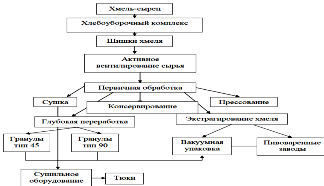
Рис. 1. Схема послеуборочной переработки хмеля
