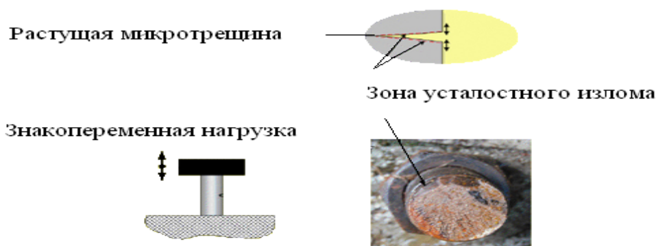
Рис. 1. Усталостный излом шпилек
