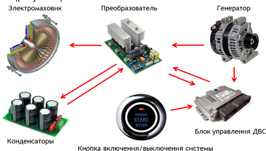
Рис. 1. Схема системы автоматического перезапуска ДВС
