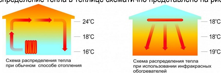
Рис. 1. Схема работы ИК-обогревателей
