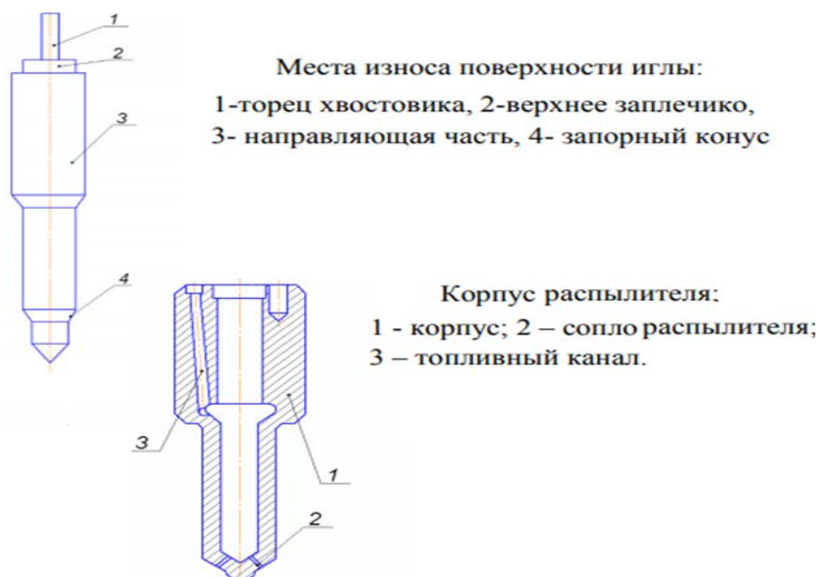
Рис. 1. Корпус и игла распылителя форсунки
