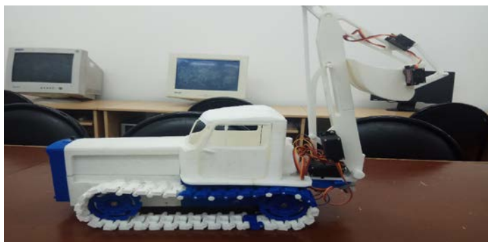
Рис. 1. Модель машины для добычи торфа со специальным рабочим органом на базе трактора ДТ-75 напечатанная на 3Д принтере
