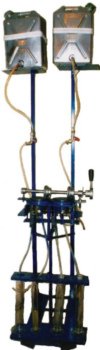
Рис. 4. Устройство смесителя для приготовления растворов различной концентрации
