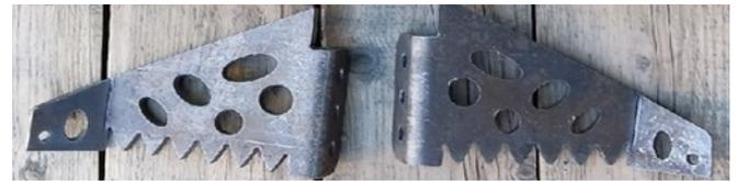
Рис. 9. Изготовленные модернизированные почвообрабатывающие пластины глубокорыхлителя
