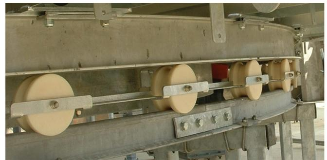
Рис. 3. Движители доильной платформы – опорные колеса с рельсами (верхний рельс подвижный, нижний – неподвижный)
