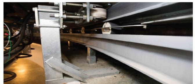
Рис. 4. Боковые направляющие и опорные колеса (вид изнутри)
