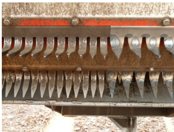
Рис. 8. Очесывающие гребенки жатки «Озон»: слева – стандартные; справа – с большим раствором между зубьями
