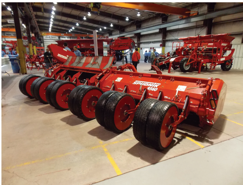
Рис. 2. Ботводробитель с дополнительным орудием в виде прикатывающих колес
