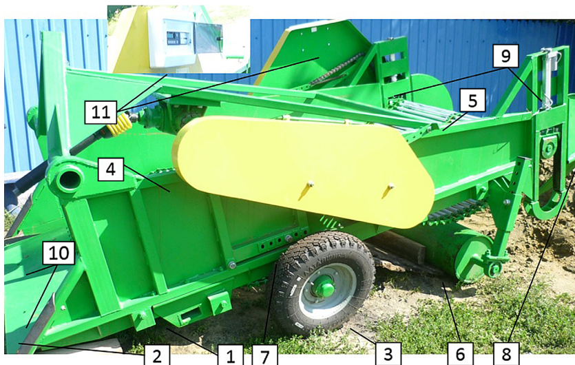
Рис. 3. Общий вид машины для уборки корнеплодов и лука, оснащённой сепарирующим прутковым элеватором с регулируемым углом наклона полотна: 1 – рама; 2 – лемех подкапывающий; 3 – колеса опорные; 4 – основной сепарирующий прутковый элеватор; 5 – дополнительный прутковый элеватор; 6 – каток-ложеобразователь; 7 – плита регулировочная встряхивателя; 8 – лоток сужающий; 9 – электроцилиндры; 10 – датчик веса лемеха подкапывающего; 11 – микроконтроллер
