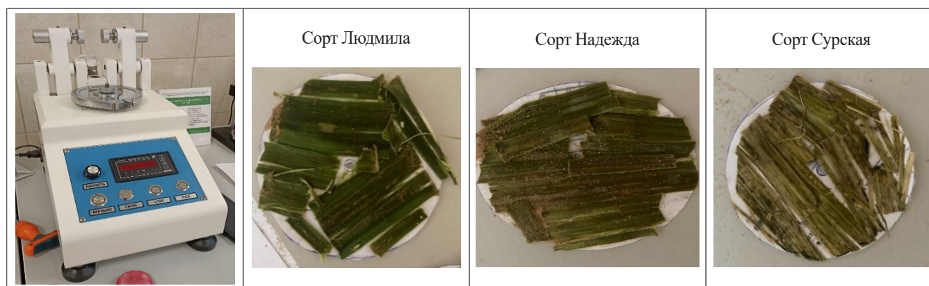
Рис. 1. Общий вид абразиметра АТ-100 и образцы технической конопли Fig. 1. General view of the AT-100 abrasive meter and samples of plant material
