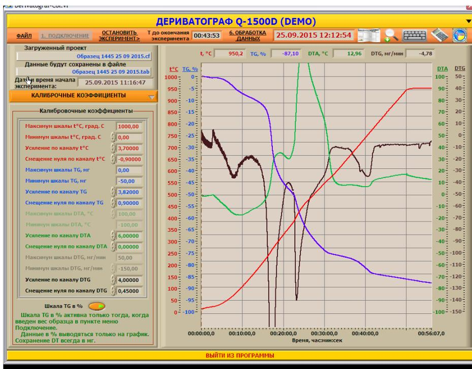
**Рис. 1. Термограмма образца № 1 – помет:**
