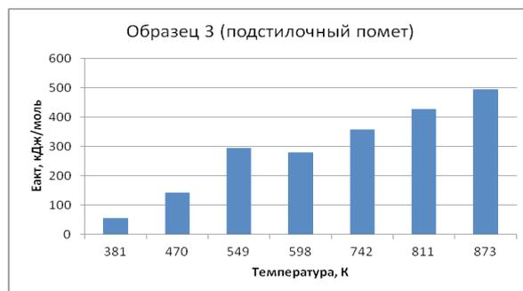
Рис. 6. Энергии активации воды и органических компонентов в зависимости от температуры (К), для образца № 3 – помет с опилками
