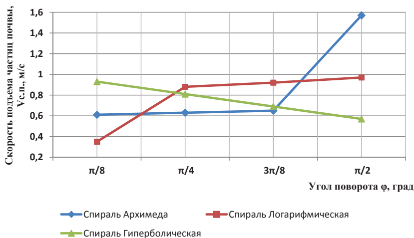
Рис. 4. Зависимость скорости подъема частицы почвы от формы поверхности заделывающего элемента Fig. 4. The relationship between the rate of soil particle lifting up and the surface shape of an embedding element
