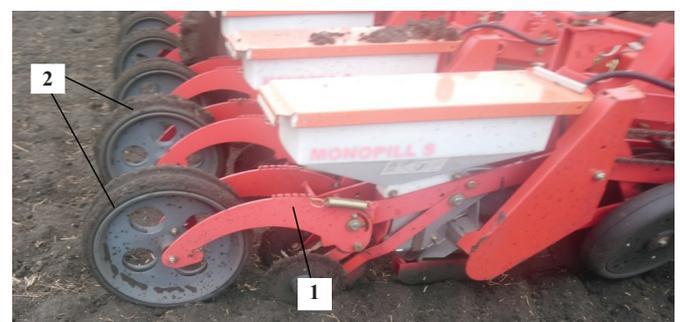
**Рис. 4. Сошниковая секция посевной машины «Monopil S15/12»:**
