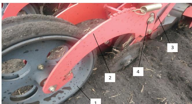
**Рис. 7. Изменение глубины погружения прикатывающих катков в почву:**
