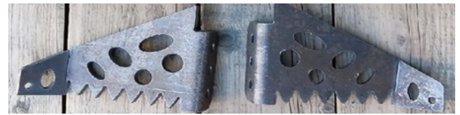
Рис. 9. Изготовленные модернизированные почвообрабатывающие пластины глубокорыхлителя
