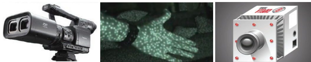
Рис. 1. Технологии наблюдения трёхмерного пространства, соответственно: стереозрение, структурированный свет, времяпролётная камера
