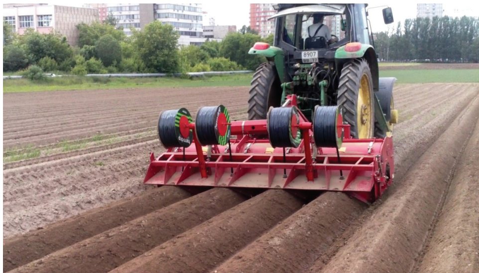
Рис. 3. Укладчик капельной ленты на базе гребневателя Grimme GF 75/4
