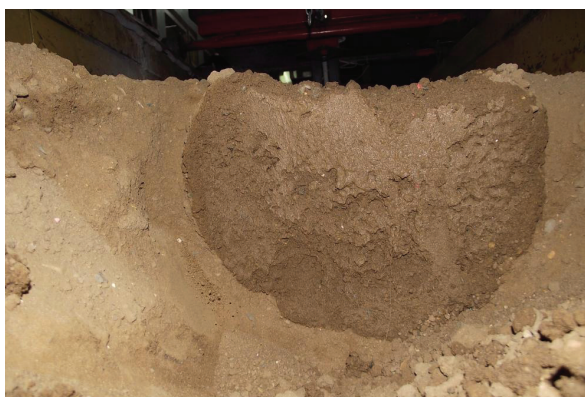
Рис. 2. Контур увлажнения капельницы с расходом 2 л/ч
