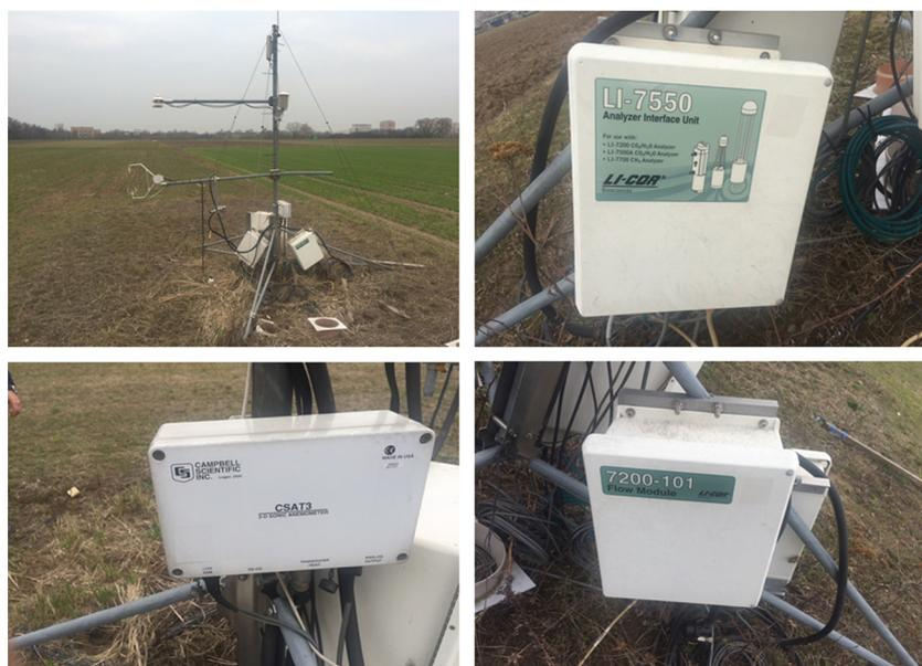
**Рис. 1. Метеостанция с комплектом цифровых датчиков**
