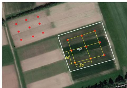
Рис. 4. Опытная схема расположения датчиков на Полевой опытной станции РГАУ-МСХА имени К.А. Тимирязева
