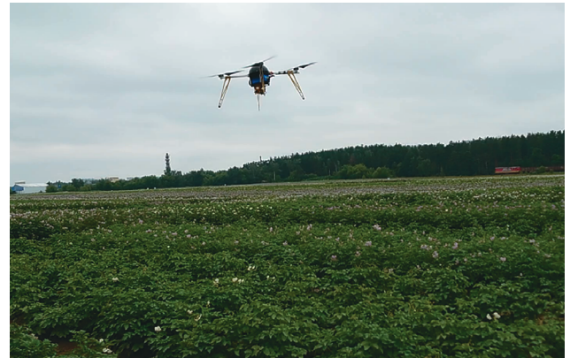
Рис. 4. Полевые испытания опрыскивания растений картофеля дроном (ООО «АгроДрон»)
