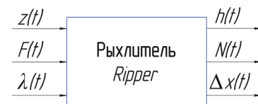
Рис. 1. Динамическая модель навесного мелиоративного рыхлителя:
