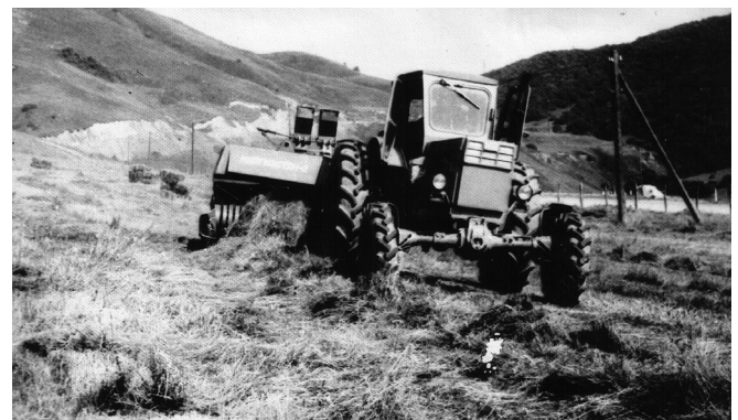
Рис. 2. Пресс-подборщик ПСБ-1,6Г. Работа на склоне
