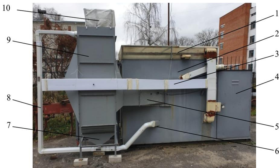
**Рис. 4. Сушилка с материалопроводом пневмотранспортера прямоугольного сечения 120 × 60 мм:**
