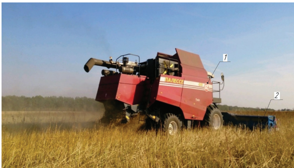
Рис. 3. Работа комбайна в загоне: 1 – комбайн КЗС-1218 «ПАЛЕССЕ GS12»; 2 – очесывающая жатка «ОЗОН»
