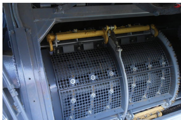
Рис. 1. Молотильно-сепарирующее устройство аксиально-роторного зерноуборочного комбайна RCM-181 «Torum 740»
