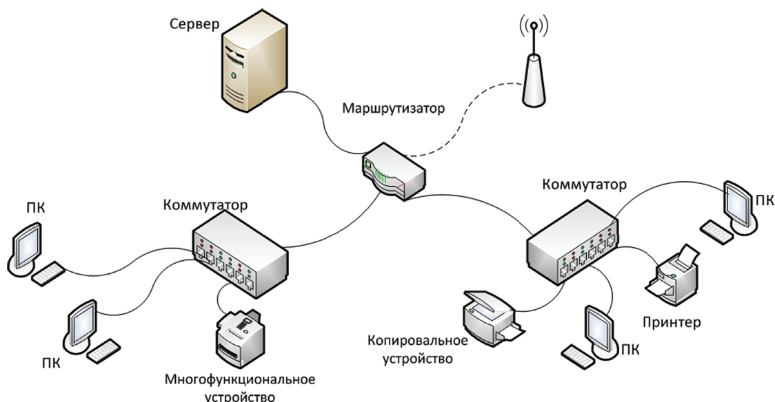
Рис. 1. Физическая схема сети складского хозяйства
