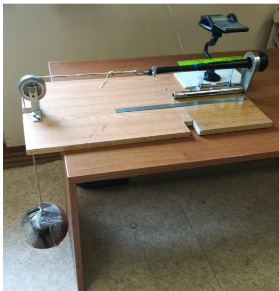
Рис. 2. Стенд для измерения удлинения сосковой резины с фотоаппаратом для регистрации состояния поверхности сосковой резины
