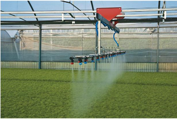
Рис. 6. Подвижная верхняя спринклерная система
