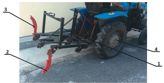
Рис. 3. Лабораторный образец агрегата для щелевания деградированных горных лугов и пастбищ:
