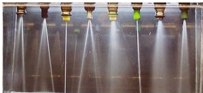
Рис. 3. Изменение формы распыла в результате износа сопла
